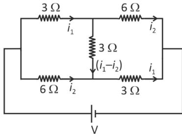
$$-3i_1 - 3(i_1 - i_2) + 6i_2 = 0 \quad \dots(1)$$
